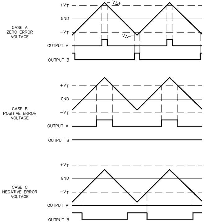
FIGURE 2 - PULSE WIDTH MODULATION WITH NO DEADBAND
